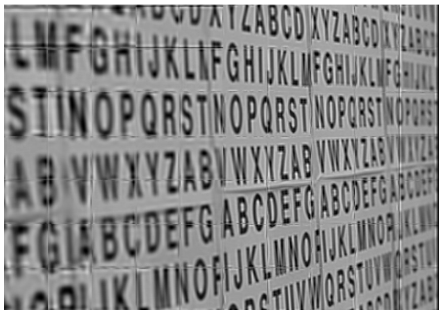
Figure 6-17: (d) Restored using actual PSF (Inv. Abel Transform)
